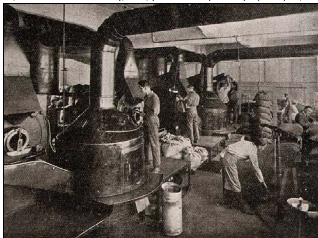
Chladicí bubny zastaví procesy vzniklé z pražení a uchovávají aroma kávy, která šla opět do pytlů, z nichž některé putovaly rovnou do filiálek.
