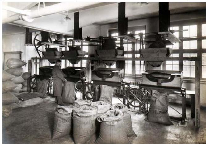
Chladicí bubny zastaví procesy vzniklé z pražení a uchovávají aroma kávy, která šla opět do pytlů, z nichž některé putovaly rovnou do filiálek.
